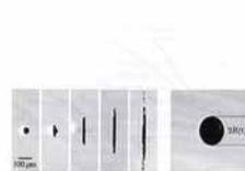
**Figuur 1** De laserpuls produceert een thin plasma op de plek waar de druppel gezakt is. De druppel krijgt daardoor snellheid en wordt in een plate pannenkoek. De vervormde druppel is hier te zien op verschillende tijdstippen na de laserpuls. Rechts een voorzetstuk (zonder een hoek van 30 graden) van de laatste druppel. Het plasma is te zien als een witte vlak in deze stereoscopische opnamen.
